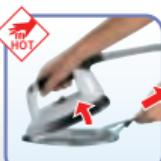
Снять насадку SOFTPRESSING ещё горячей и очистить её
